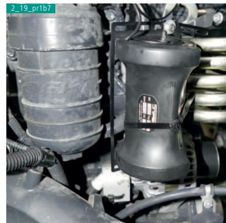
**Bild 7. Perlix**, der über ein Kabel mit der (elektrischen) Masse am Motor des Nutzfahrzeugs verbunden ist.
